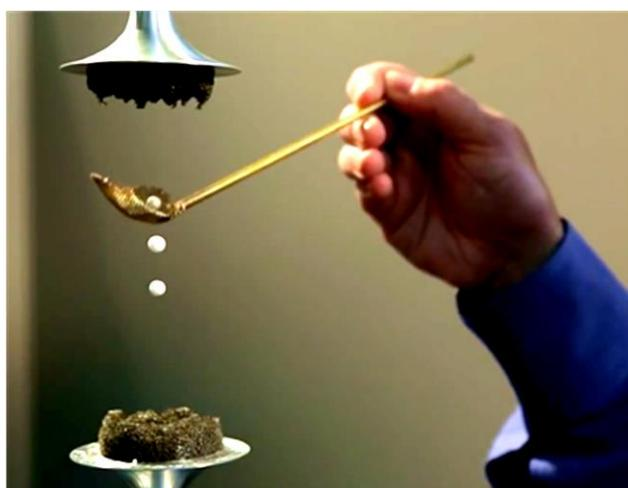
Fig. 6 Experimento de levitación acústica en Argonne National Laboratory (Chicago, USA), [3]
