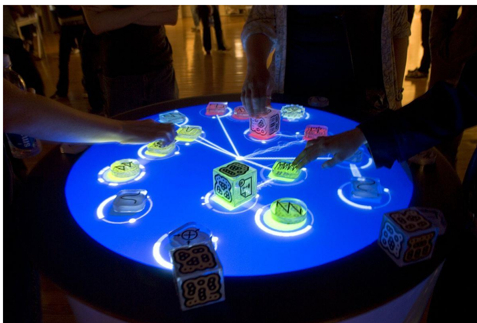
Fig. 4 El Reactable es un instrumento musical basado en una interfaz tangible. Diferentes objetos físicos con patrones integrados se colocan sobre una mesa que los distingue. Como se ve en la imagen la interacción puede ser colaborativa. El Reactable es un ejemplo interesante de cómo interactuar a través de interfaces físicas en lugar de gráficas
