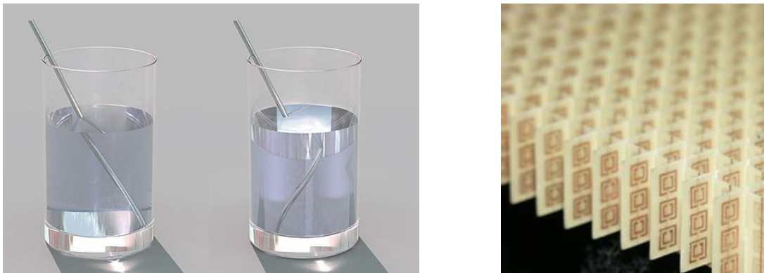
Fig. 49 Izquierda) el vaso de la izquierda muestra la distorsión real creado por el agua; en el vaso de la derecha, se ilustra un caso imaginario en el que el agua tuviese características de metamaterial y su efecto sobre la deformación de la imagen; derecha) agrupación periódica de tramos rectilíneos conductores y espiras con el objetivo de sintetizar permeabilidades y permitividades negativas en una determinada frecuencia
