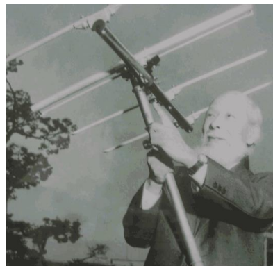
Fig. 24 La antena Yagi-Uda inventada por los japoneses Hidetsugu Yagi (en la fotografía) y Shintaro Uda en el año 1926 donde se observa la agrupación de diversos segmentos conductores dispuestos paralelamente
