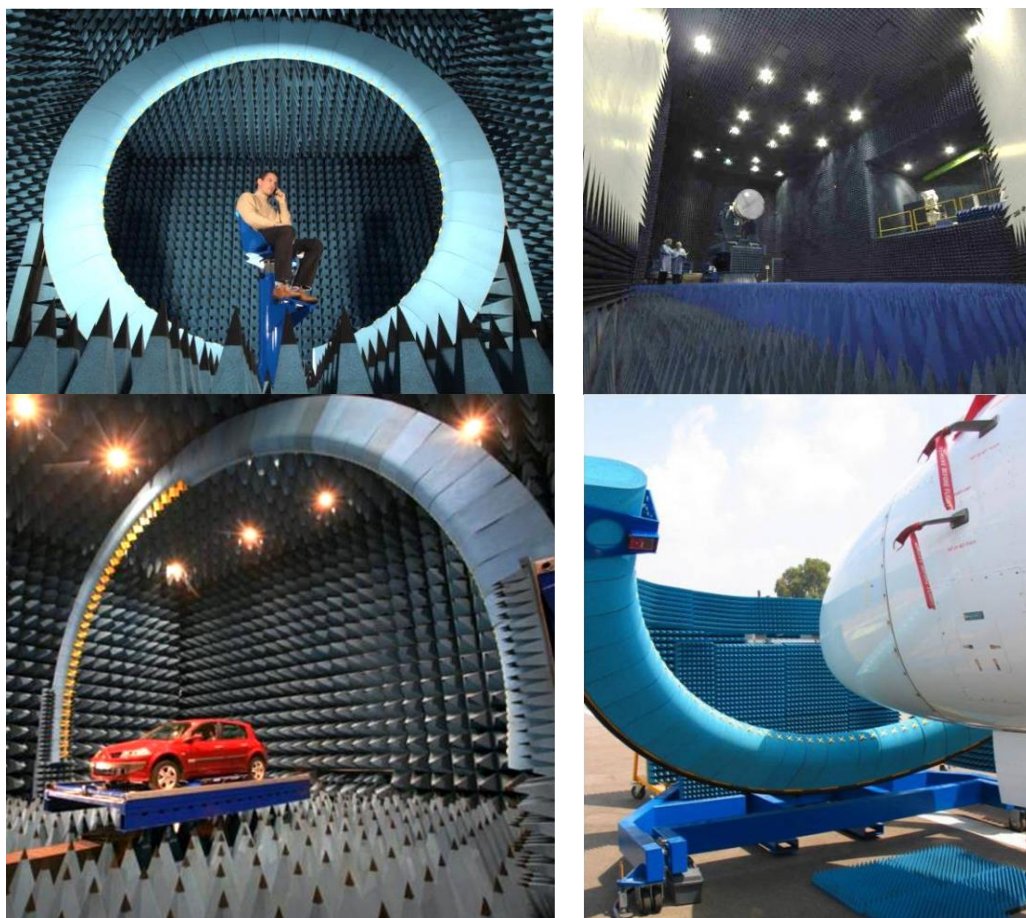
Fig. 38 Cámaras anecoicas para la medida de antenas integradas en dispositivos móviles teniendo en cuenta el cuerpo humano; para antenas integradas en satélites, coches y aviones. Cámara de Satimo y ESA (European Space Agency)
