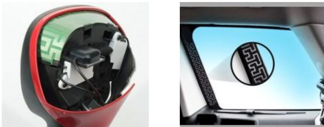
Fig. 50 Izquierda) antena integrada en el retrovisor; derecha) antena integrada en la ventana lateral. Gentileza de la empresa Ficosa International, Advanced Communications BU, Barcelona
