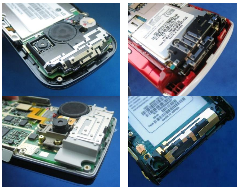
Fig. 52 Antenas comerciales de teléfonos móviles. Las formas responden a requisitos de funcionamiento: tienen que ser lo suficientemente pequeñas para integrarse en el teléfono y deben operar en varios sistemas de telecomunicación de telefonía móvil
