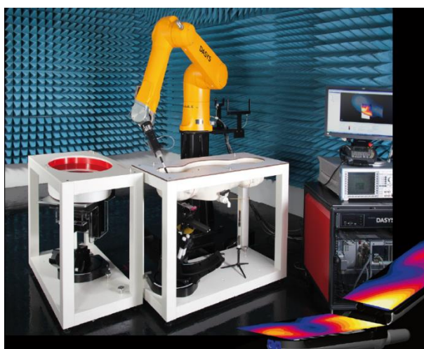
Fig. 40 Equipo de medida de SAR formado por un brazo robot articulado provisto de una sonda en su extremo, capaz de medir el campo eléctrico en el interior de una cabeza maniquí llena de líquido que emula el cerebro humano a las frecuencias de interés
